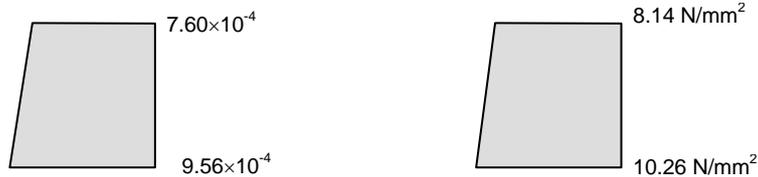
Figura 6.15. Deformaciones y tensiones en el hormigón a largo plazo
