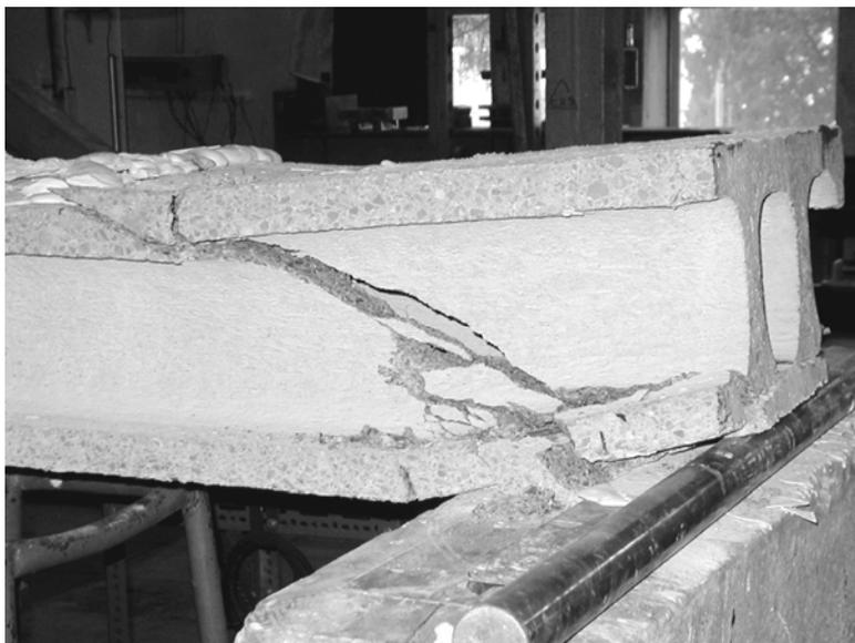
Figura 7.5. Rotura de cortante
