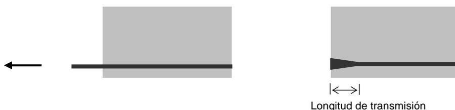
Figura 3.27. Longitud de transmisión
