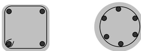
Figura 9.1. Secciones de pilares, cuadrada y circular
