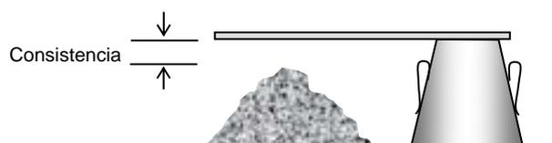
Figura 3.3. Ensayo de consistencia
