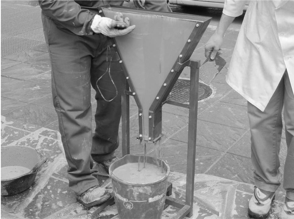
Ensayo de hormigón autocompactante. ETSICCP UGR.
