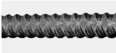
Figura 3.22. Barras de pretensado
